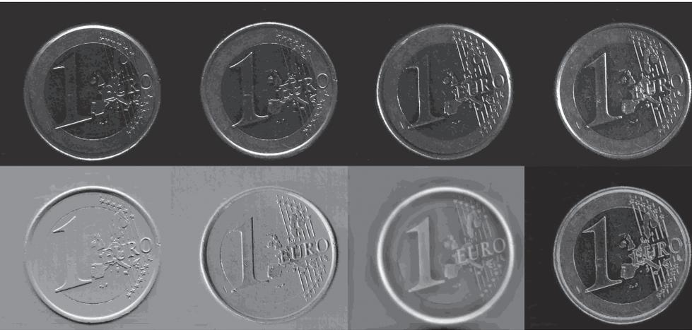
**Bild 2.** Jeder kleine Kratzer ist deutlich zu erkennen. Eine weitere Optimierung am Shape-from-Shading-CIS liefert in Verbindung mit der MVTec Software nochmals bessere Bilder. © Tichawa Vision GmbH
